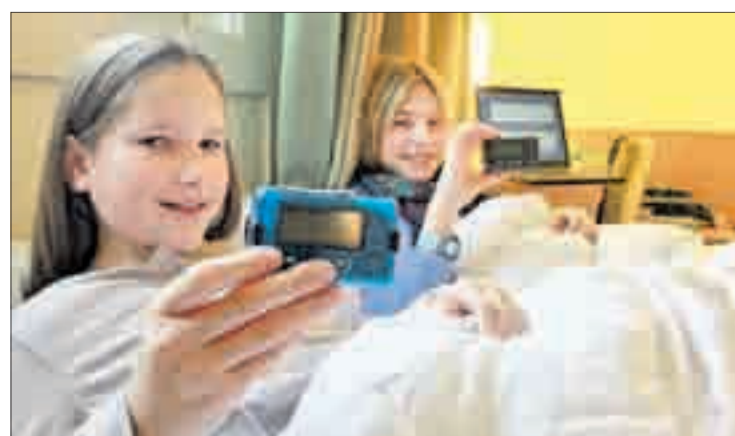
Sophie (vorn) und Lea zeigen die kleinen Pumpen, die sie mit Insulin versorgen. Ein Laptop auf dem Nachttisch sendet die Daten für die benötigte Menge direkt an die Minigeräte. Steiner
